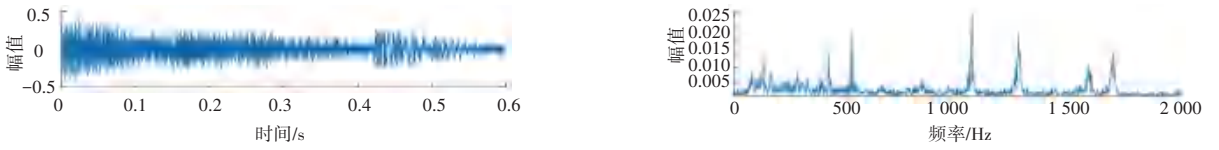
图 2 VMD 处理的汽车鸣笛声时域及频域图
