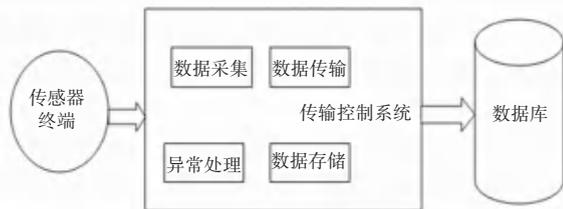
图2 底层传输控制系统总体结构
