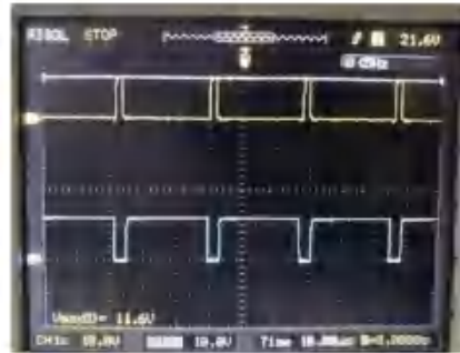
图 13 放电模式下的两路反相互补的波形
