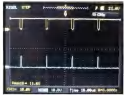
图 12 充电模式下的两路反相互补的波形
