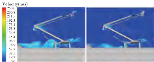
图8 主被动整体降噪后湍动能分布对比(量程: 0 \sim 250 \text{ m}^2/\text{s}^2 )
